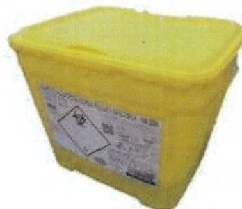
**Essai:** Essai conforme 'emballages pour déchets d'activités de soins', selon NF X30-511**Essais effectués:**
